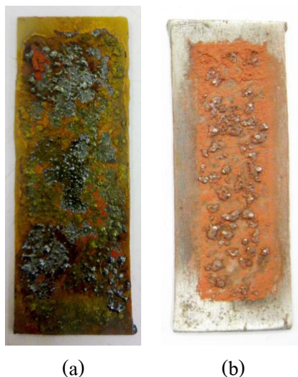
รูปที่ 31 ผิวเคลือบที่สังเคราะห์ได้จากระบบที่ใช้ a) พอลิไวนิลแอลกอฮอล์ และ b) เมทิลเซลลูโลส เป็นตัวประสาน
