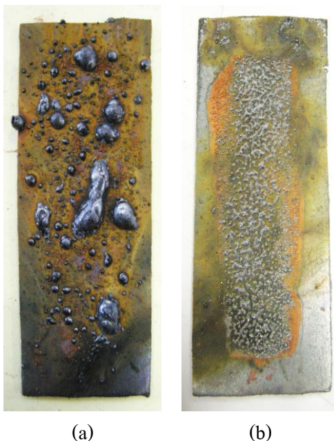
รูปที่ 39 ผิวเคลือบที่สังเคราะห์ได้จากการทดลองที่ใช้ส่วนผสมตั้งต้นเป็น a) ผง และ b) คอลลอยด์
