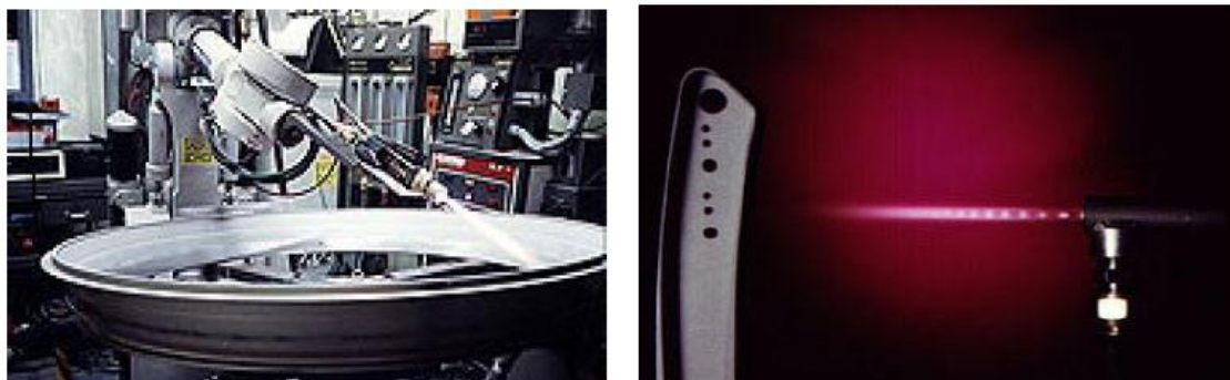
รูปที่ 7 ลักษณะการพ่นเคลือบด้วยระบบ HVOF ( http://www.5tigers.co.th สืบค้นเมื่อ 13 ธันวาคม 2552)
