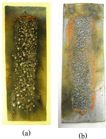
รูปที่ 35 ผิวเคลือบที่สังเคราะห์ได้จากการทดลอง a) ไม่มีการให้ความร้อนก่อนการจุ่มระเบิดผิวเคลือบตั้งต้น และ b) มีการให้ความร้อนก่อนการจุ่มระเบิดผิวเคลือบตั้งต้น
