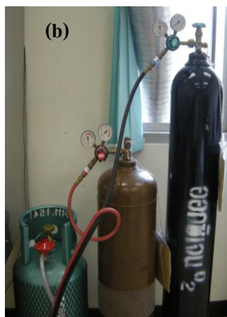
รูปที่ 27 วัสดุ อุปกรณ์ และเครื่องมือที่ใช้ในกระบวนการเคลือบ (a) Fume Hood (b) Oxy-acetylene Gas Set และ (c) Powder Spraying Torch
