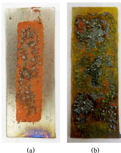
รูปที่ 32 ผิวเคลือบที่สังเคราะห์ได้จากการทดลองที่ใช้สารละลายตัวประสานที่มีพอลิไวนิลแอลกอฮอล์ในสัดส่วน a) ร้อยละ 1 โดยน้ำหนัก และ b) ร้อยละ 2 โดยน้ำหนัก
