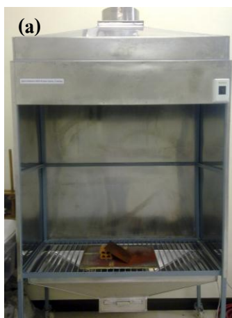
รูปที่ 27 วัสดุ อุปกรณ์ และเครื่องมือที่ใช้ในกระบวนการเคลือบ (a) Fume Hood (b) Oxy-acetylene Gas Set และ (c) Powder Spraying Torch
