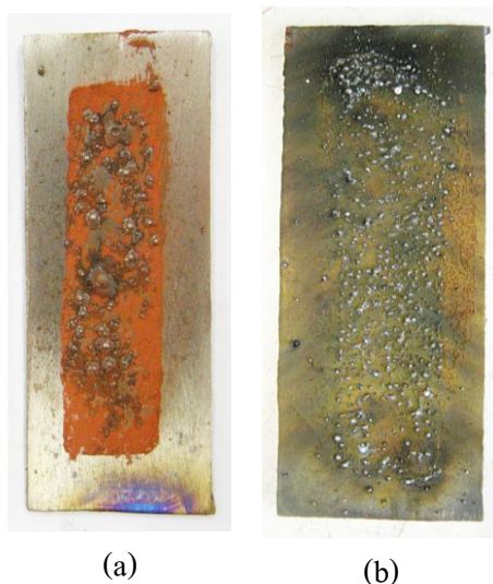
รูปที่ 33 ผิวเคลือบที่สังเคราะห์ได้จากการทดลองที่ใช้สารละลายตัวประสานที่มี a) น้ำกลั่น และ b) เอทิลแอลกอฮอล์ เป็นตัวทำละลาย
