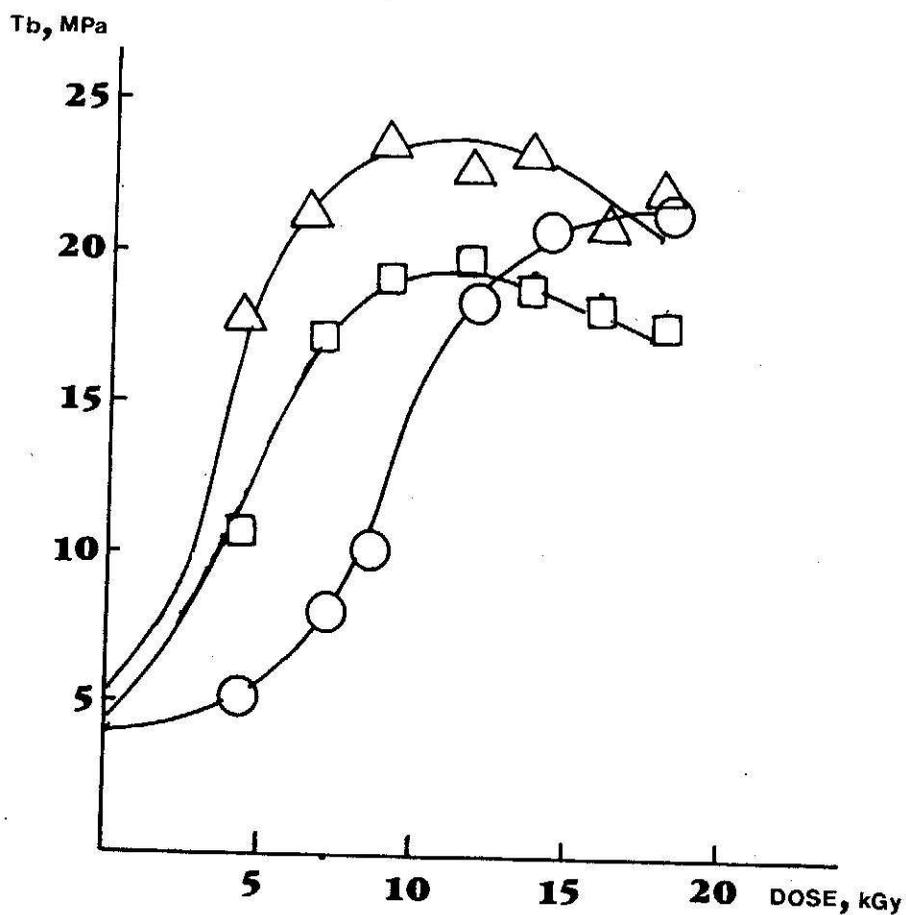
รูปที่ 5. ค่าทนแรงดึงได้สูงสุดของแผ่นยางที่เตรียมได้จากน้ำยางธรรมชาติแหล่ง ช.
