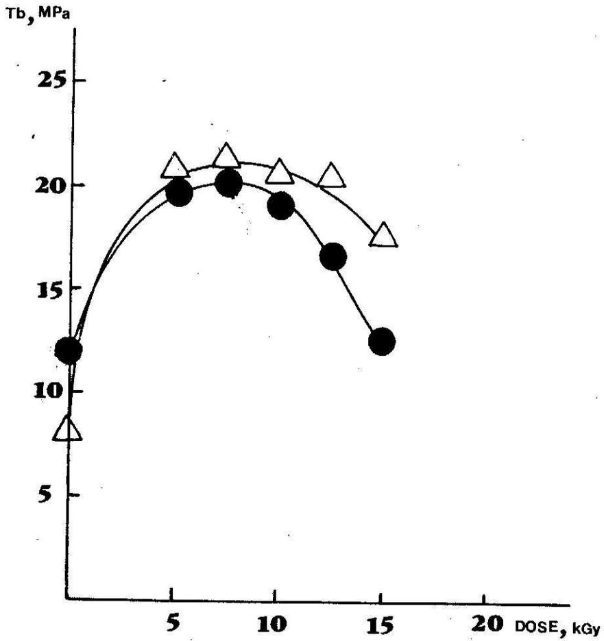
รูปที่ 6. ค่าทนแรงดึงได้สูงสุดของแผ่นยางที่เตรียมได้จากน้ำยางธรรมชาติแหล่ง ก. ที่โดสละสมต่าง ๆ เมื่อใช้สารไวปฏิกิริยาต่างชนิดกัน
