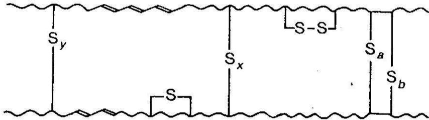
รูปที่ 1 แผนภาพแสดงโครงสร้างอย่างง่ายของโมเลกุลยางที่เกิดครอสลิงค์ด้วยสะพานซัลไฟด์
