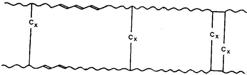
รูปที่ 3 แผนภาพแสดงโครงสร้างไม่เหลกกลางเมื่อเกิดการครอสลิงค์ด้วยสะพานไมโนเมอร์ เมื่อวัลคาไนส์น้ำยางด้วยรังสีโดยใช้ไมโนเมอร์เป็นสารไวปฏิกิริยา
