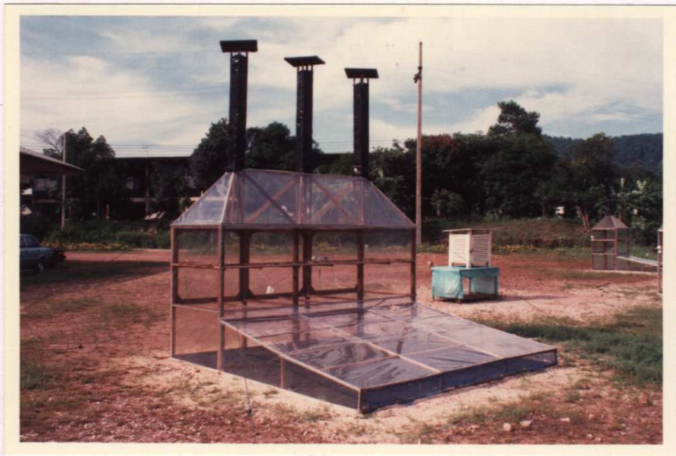
รูปที่ 2 เครื่องอบแห้งพลังงานแสงอาทิตย์แบบขยาย 3 เถ้าของต้นแบบ
