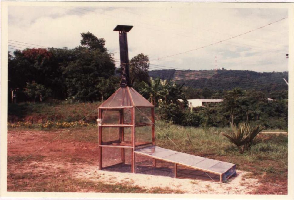
รูปที่ 1 เครื่องอบแห้งพลังงานแสงอาทิตย์ต้นแบบ (อก-1)
