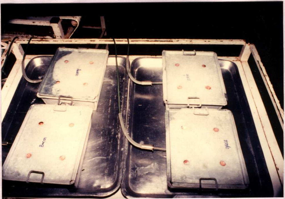
ภาพผนวกที่ 4 การบรรจุกล่องและการเสียบ thermocouple
