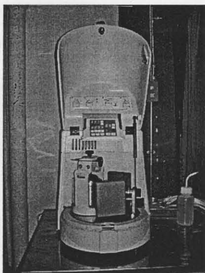
รูปที่ 3.2 เครื่องบดสารเคมี (planetary ball mill)
