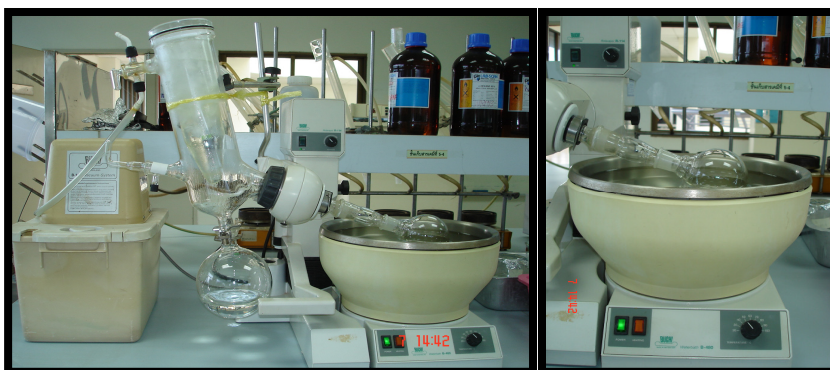
ภาพประกอบที่ 14 แสดงการลดปริมาตรด้วยเครื่อง rotary evaporator
