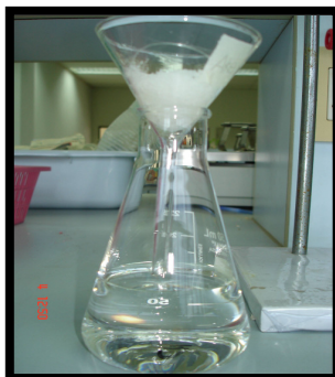
ภาพประกอบที่ 13 แสดงการกรอง Dichloromethane ด้วย \text{Na}_2\text{SO}_4 ผ่าน wool
