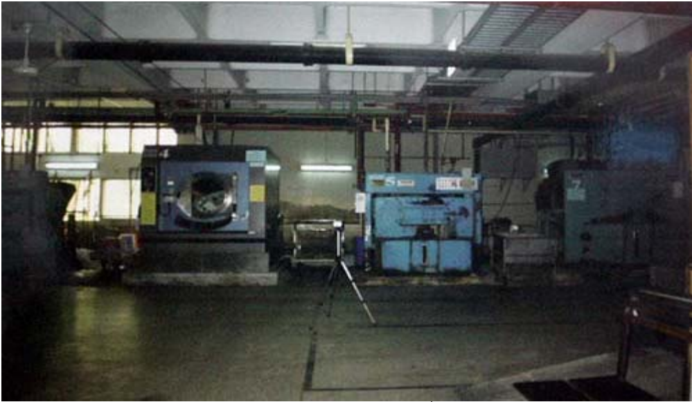
ภาพประกอบภาคผนวก 3 การวัดระดับความดังเสียงที่จุดปฏิบัติงาน ในงานซัก-อบ-รีด แผนก จ่ายผ้ากลาง
