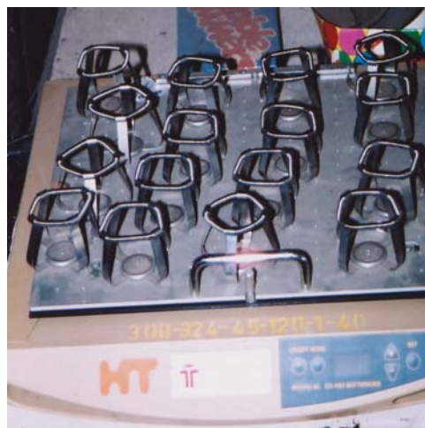
ภาพประกอบ จ-4 เครื่องเขย่า ใช้ในการทดลอง แบบไม่ ต่อเนื่อง
