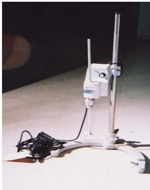
ภาพประกอบ จ-2 เครื่องกวน ใช้ในการเตรียมตัวดูดซับ
