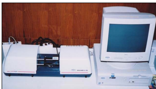
ภาพประกอบ 2.4 UV/VIS spectrophotometer (SPECORD S 1000)
