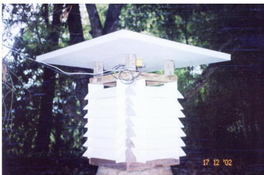
รูปที่ 3.13 อุปกรณ์ประยุกต์ สำหรับติดตั้งหัววัดอุณหภูมิอากาศ
