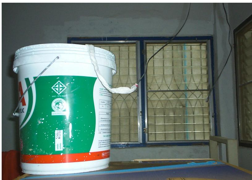
รูปที่ 3.15 เครื่องมือวัดความขึ้นอากาศ โดยประยุกต์จากเครื่องมือวัดอากาศ
