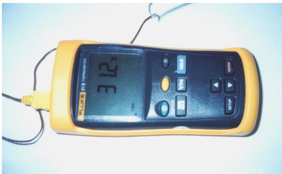
รูปที่ 3.12 เครื่องวัดอุณหภูมิมาตรฐาน ( Fluke รุ่น 51 II )
