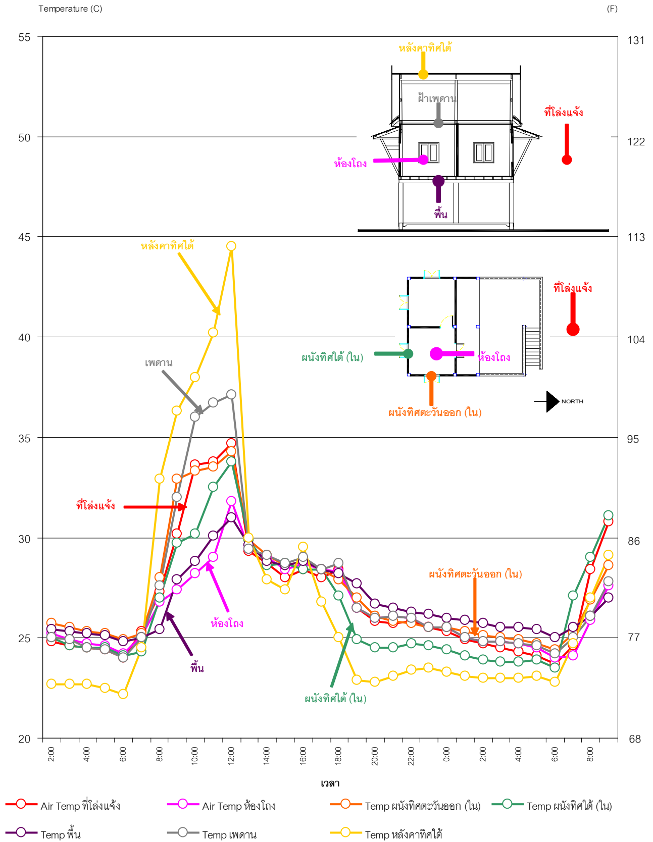
รูปที่ 4.74 การเปรียบเทียบอุณหภูมิอากาศห้องโถงกับเปลือกอาคาร บ้านมวลสารน้อย เปิดการระบายอากาศ ภูมิอากาศแบบฝนตก วันที่ 16 ตุลาคม 2546
