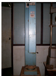
(b) บดอัดดินด้วยเครื่องบดอัดอัตโนมัติ (ELE Automatic Compactor)
