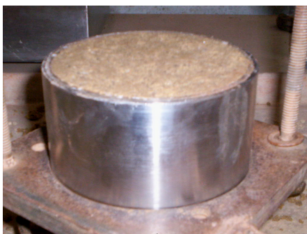
(a) การบรรจุดินใน Mold ตาม วิธีมาตรฐาน Standard
