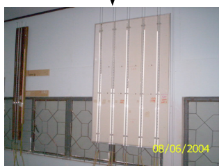
(e) อ่านค่าระดับน้ำบน standpipe
