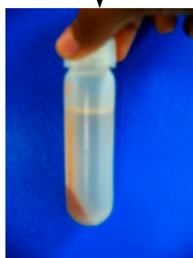
(d) นำสารละลายโลหะหนักที่แยกชั้น อยู่ด้านบนไปตรวจวิเคราะห์หา ความเข้มข้นสุดท้าย
