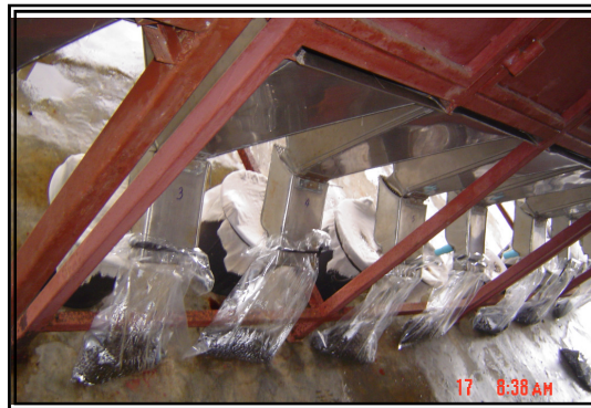
ภาพที่ 6 ภาชนะที่รองรับมูลและปัสสาวะ ใต้กรงทดลองหาการย่อยได้
