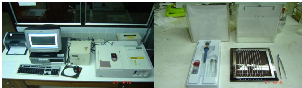
รูปที่ 3.10 ชุดทดสอบวิเคราะห์หาองค์ประกอบด้วยเทคนิค Thin Layer Chromatography
