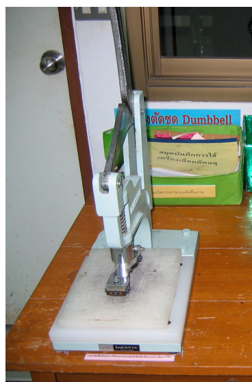
รูปที่ 3.7 ชิ้นทดสอบแบบดัมเบล ASTM D412 (Die C)
