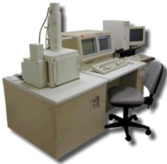
รูปที่ 2.5 เครื่องวิเคราะห์รูปร่างและการแตกของอนุภาค (Scanning electron microscope)
