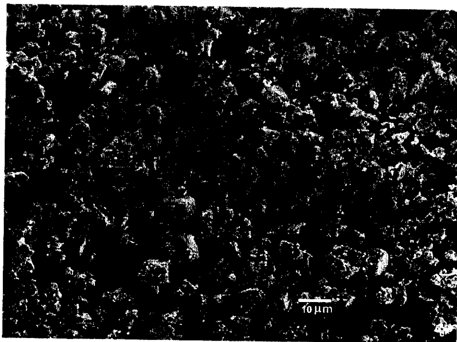
รูปที่ 3.100 ลักษณะของอนุภาคแร่แบไรต์ที่ได้จากการอบค(กำลังขยาย 1000 เท่า)
