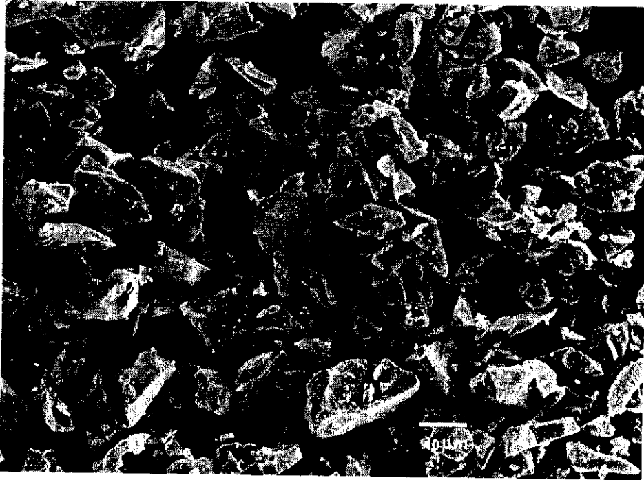
รูปที่ 3.106 ลักษณะของอนุภาคแร่ควอร์ตซ์ที่ได้จากการบด(กำลังขยาย 1000 เท่า)
