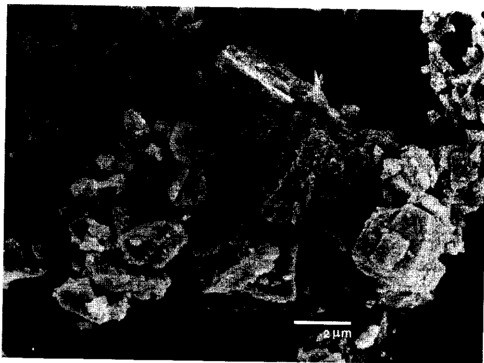
รูปที่ 3.101 ลักษณะของอนุภาคแร่แบไรต์ที่ได้จากการอบค(กำลังขยาย 8000 เท่า)
