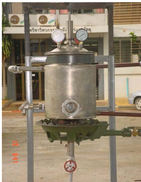
ภาพที่ 20 ถังปฏิกรณ์ที่ใช้ในการทำปฏิกิริยาคลอรีนไฮโดรไลซิส
