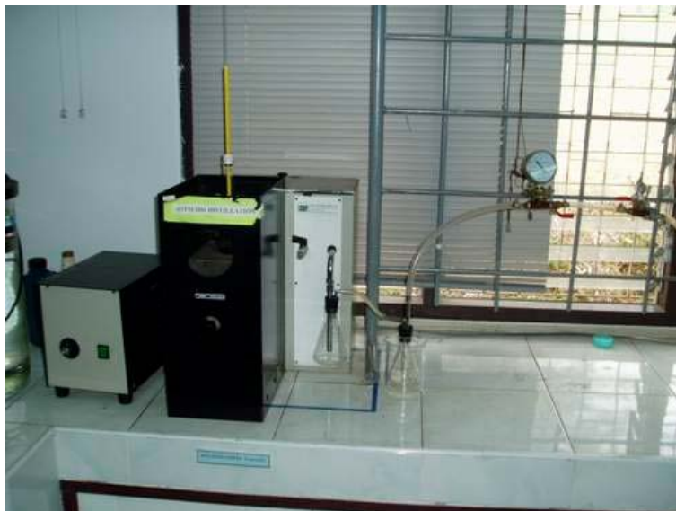
ภาพที่ 22 ชุดกลั่นที่ได้จากการประยุกต์เครื่องกลั่น ASTM D86
