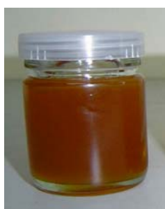
รูปที่ 17 ผลการสกัดน้ำมันในเนื้อในเมล็ดยางพาราด้วยเฮกเซนเป็นตัวทำละลายที่อัตราส่วนของเนื้อในเมล็ดยางพาราท่อเฮกเซน 1 : 2 โดยน้ำหนัก กวนเป็นเวลา 3 ชั่วโมง
