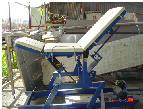
ภาพประกอบ 3-48 ผลการประกอบ โครงสร้างเตียงกายภาพบำบัด
