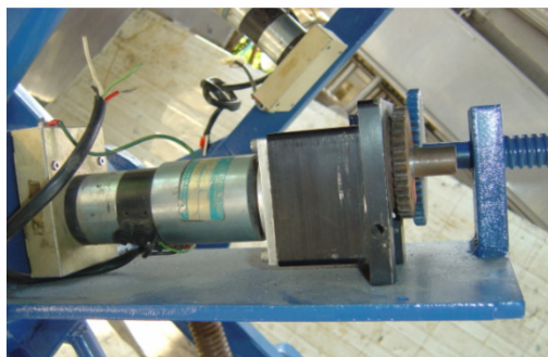
ภาพประกอบ 3-50 มอเตอร์ที่ใช้ในการจับส่วนหัว (Head section)
