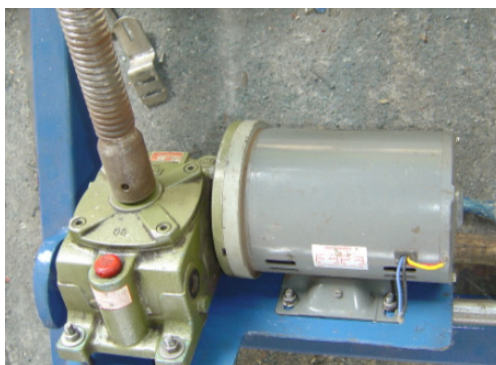
ภาพประกอบ 3-53 มอเตอร์ที่ใช้ในการขับเคลื่อนส่วนฐาน (Base section)
