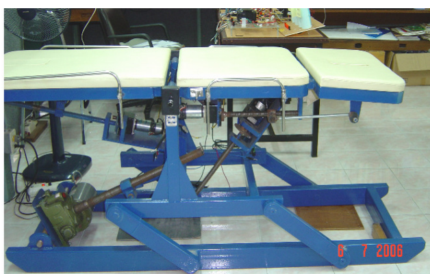
ภาพประกอบ 3-54 ผลการติดตั้งระบบขับเคลื่อน
