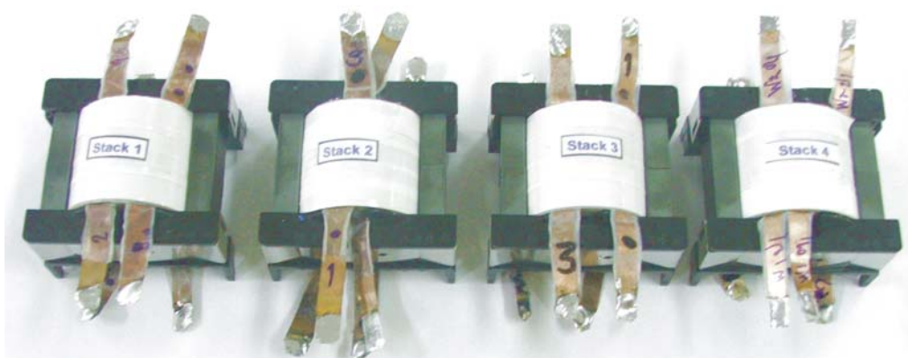
ภาพประกอบ 3-16 หม้อแปลงไฟฟ้าความถี่สูงแบบ Stack ที่ใช้ในการทดสอบ
