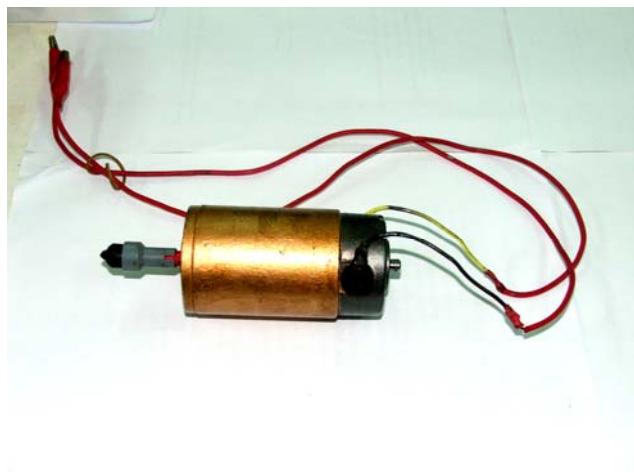
ภาพประกอบ 4-12 Tacho-generator สำหรับวัดความเร็วรอบมอเตอร์
