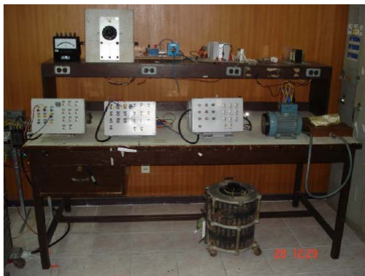
ภาพประกอบ 4-3 มอเตอร์สำหรับการทดลอง 3 ขนาด ( 0.5 , 1.5 , 2 hp , 50-Hz)
