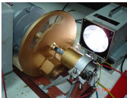
ภาพประกอบ 4-13 การต่อคัปปลิ้ง Tacho-gen เข้ากับแกนมอเตอร์
