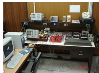
รูปที่ 8 ทดสอบมอเตอร์ 3-phase, 2 hp, 220/380 volts.4 poles squirrel cage induction motot (noload -test)
