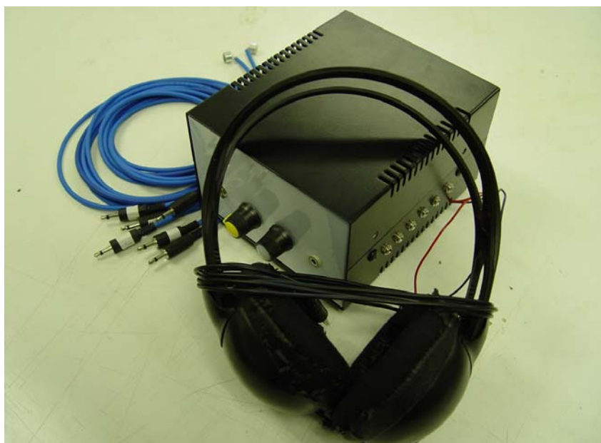
ภาพประกอบที่ 3-18 แสดงอุปกรณ์วงจรถยายสัญญาณและวงจรถยายเสียงที่จัดสร้างขึ้น
