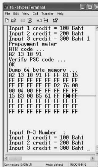
รูปที่ 4.3 เขียนข้อมูลค่าเงินเข้าสู่บัตรสมาร์ทการ์ด
