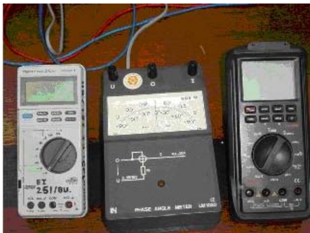
รูปที่ 7.4 เครื่องมือวัดค่าการทดสอบวงจรลัดหม้อแปลงไฟฟ้า
