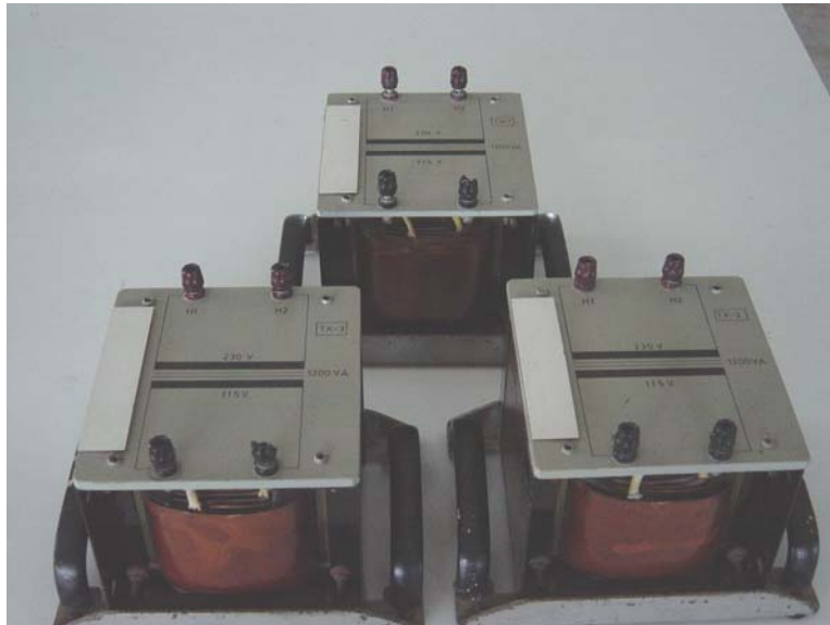
รูปที่ 7.1 หม้อแปลงทดสอบแรงต่ำ TX-1, 2,3
