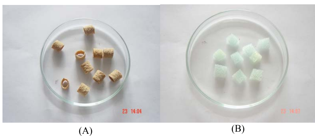
ภาพที่ 2 ลักษณะของวัสดุที่นำมาใช้ในการตรึงเซลล์ของเชื้อรา : วัสดุทางการค้า Bio stage (A), ฟองน้ำ (B)
