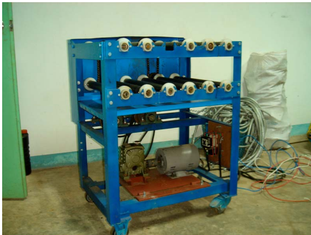
ภาพที่ 6 ภาพถ่ายของเครื่องกลิ้งขวดน้ำผึ้ง
