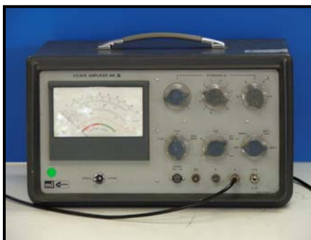
รูปที่ 3.4 เครื่องบ่งชี้ระดับสัญญาณ โดยใช้เครื่อง V.S.W.R. Amplifier MK III
