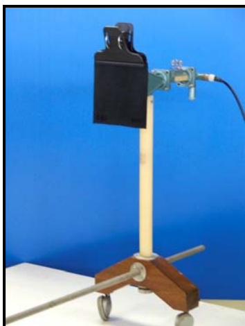
รูปที่ 3.5 การนำขึ้นทดสอบปิดหน้าสายอากาศตัวรับ
