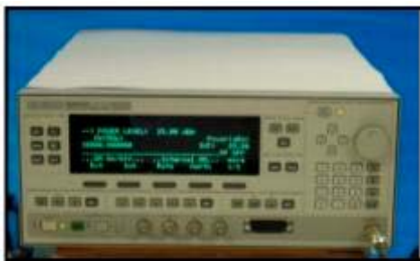
รูปที่ 3.2 เครื่องกำเนิดสัญญาณคลื่นแม่เหล็กไฟฟ้า ช่วงความถี่ 8.5 ถึง 12.0 จิกะเฮิรตซ์ รุ่น HP 83620B
