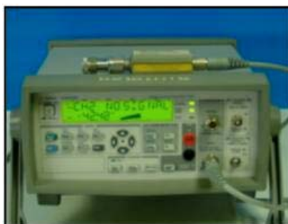
รูปที่ 3.9 เครื่องวัดกำลัง (power meter) Agilent รุ่น 53147A Power meter
