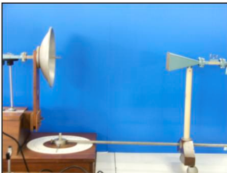
รูปที่ 3.3 อุปกรณ์ที่ใช้ในการทดสอบวัดค่าประสิทธิภาพการกำบังคลื่นแม่เหล็กไฟฟ้า (ซ้าย) สายอากาศตัวส่ง (ขวา) สายอากาศตัวรับ
