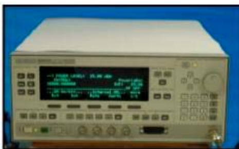
รูปที่ ก.1 เครื่องกำเนิดสัญญาณคลื่นแม่เหล็กไฟฟ้า ช่วงความถี่ 8.5 ถึง 12 จิกะเฮิรตซ์
