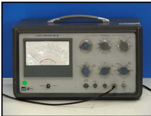
รูปที่ ก.2 เครื่องบ่งชี้ระดับสัญญาณ V.S.W.R. Amplifier MK III
