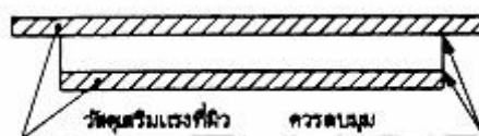
ภาพประกอบ 2.24 ตัวอย่างแผ่นยางแบบมีวัสดุเสริมแรงที่ผิว
