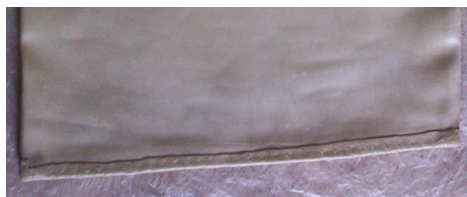
รูปที่ 3.12 ปะทับรอยเย็บด้านท้ายด้วยยางคอมปาวด์
