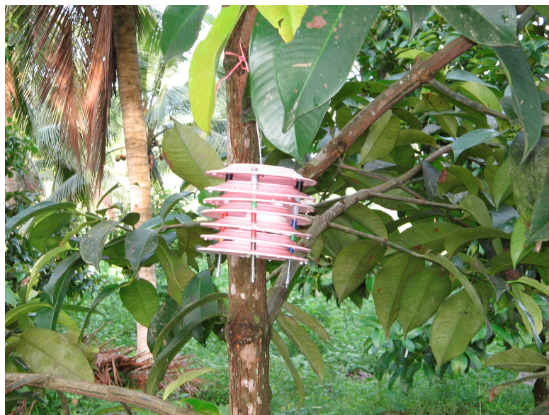
ภาพผนวกที่ 4 การติดตั้งเครื่องวัดอุณหภูมิอากาศ (Data logger HOBO Pro series RH Temp) ภายในทรงพุ่ม
