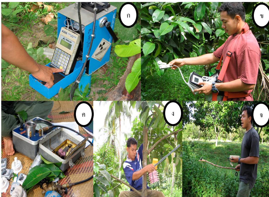
ภาพผนวกที่ 7 วัดการตอบสนองทางสรีรวิทยาหลังจากตัดแต่งทรงพุ่ม 8 เดือน ด้วยเครื่องวัดศักย์ของน้ำในใบพืช (Pressure Chamber) (ก) วัดความชื้นในดิน (Soil moisture gauge) (ข) วัดการชักนำการเปิดปากใบ (Porometer) (ค) วัดปริมาณความเข้มแสงในทรงพุ่ม (LI-250 Light meter) (ง) วัดปริมาณความเข้มแสงในและนอกพื้นที่ ทำการทดลอง (LI-190SA Quantum sensor, LI-COR USA) (จ)
