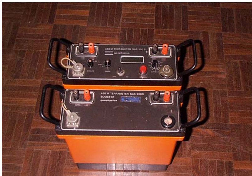
รูปที่ 14 เครื่องมือวัดสภาพค่าต้านทานไฟฟ้าของชั้นดิน ยี่ห้อ ABEM TERRAMETER SAS 300B และ Booster SAS 2000
