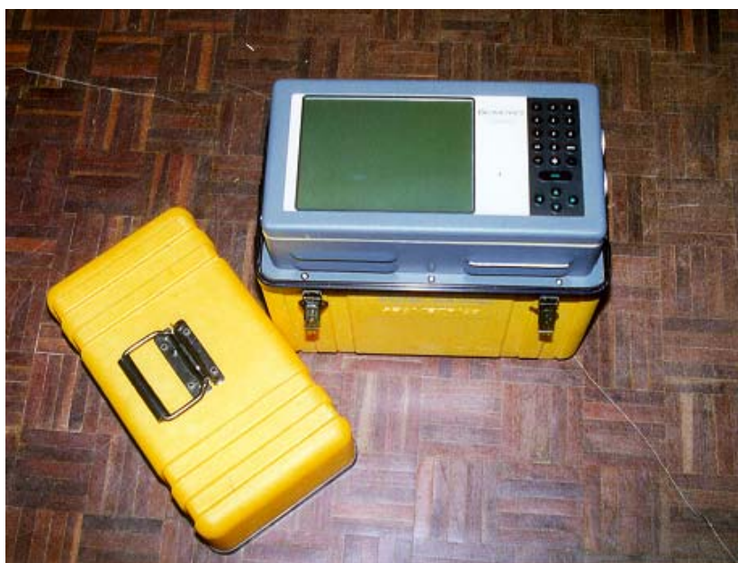
รูปที่ 15 เครื่องมือวัดคลื่นไหวสะเทือนรุ่น Geometrics SmartSies™ S-24 Seismograph
