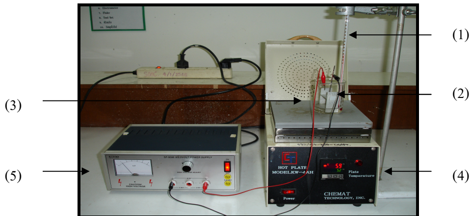
ภาพประกอบที่ 3.9 แสดงชุดทดลองการโพลิง (1) เทอร์โมมิเตอร์ (2) บีกเกอร์ (3) สารตัวอย่าง (4) เตาน้ำค้ำ (5) แหล่งกำเนิดกระแสสลับไฟฟ้าตรง
