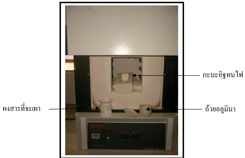
ภาพประกอบที่ 3.2 เตาเผาอุณหภูมิสูง ยี่ห้อ Lenton รุ่น AWF 13/5
