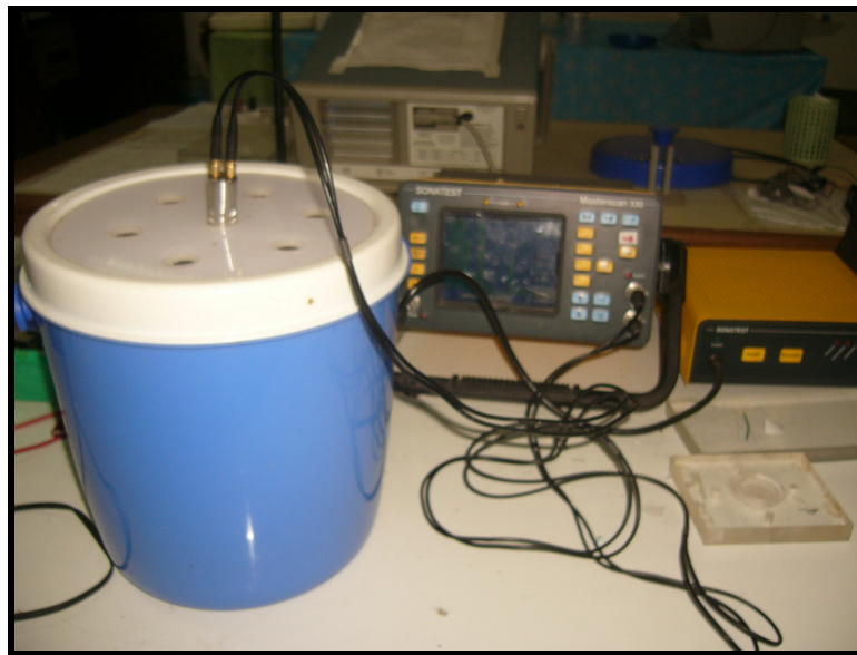
ภาพประกอบที่ 3.20 แสดงการวัดอัตราเร็วเสียงในน้ำโดยใช้อัลตราโซนิก
