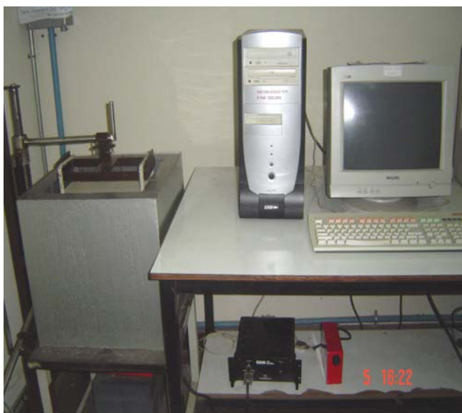
ภาพประกอบ 3.5 เครื่องวัดสเปกตรัมรังสีแกมมา หัววัด NaI(Tl)
