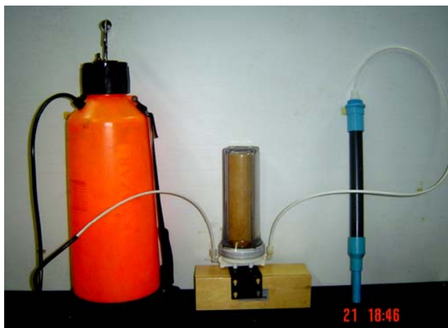
ภาพประกอบ 3.1 ชุดอุปกรณ์ที่ใช้จับเรเดียมในน้ำ
