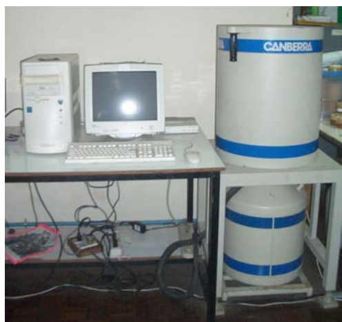
ภาพประกอบ 3.8 เครื่องวัดสเปกตรัมรังสีแกมมา หัววัด HPGe
