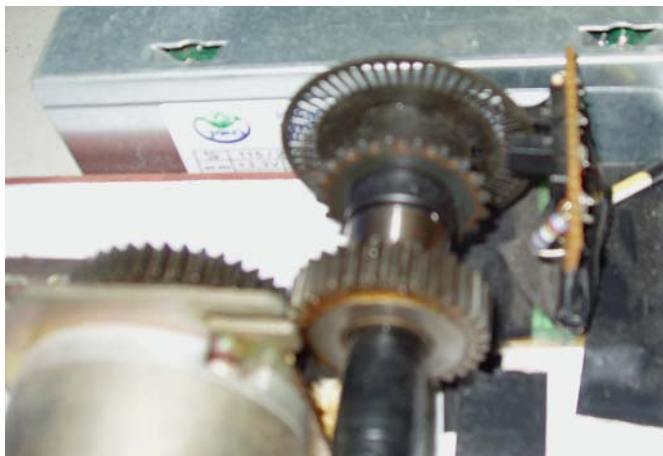
ภาพประกอบ 4-6 แสดงงานเอ็นโคเดอร์และวงจรในการวัดความเร็วของระบบ
