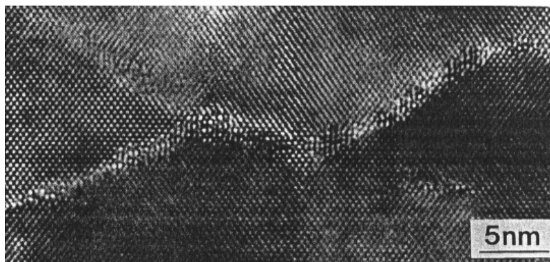
ภาพประกอบ 1.1 ภาพถ่ายกำลังขยายสูงของความบกพร่องแบบซิกเซกของระนาบ {113} ที่เกิดขึ้นบริเวณด้านล่างของชั้นได้ฟิวซิลิกอน (ที่มา : Visitserutrakul และ Krauses 1991: 700)
