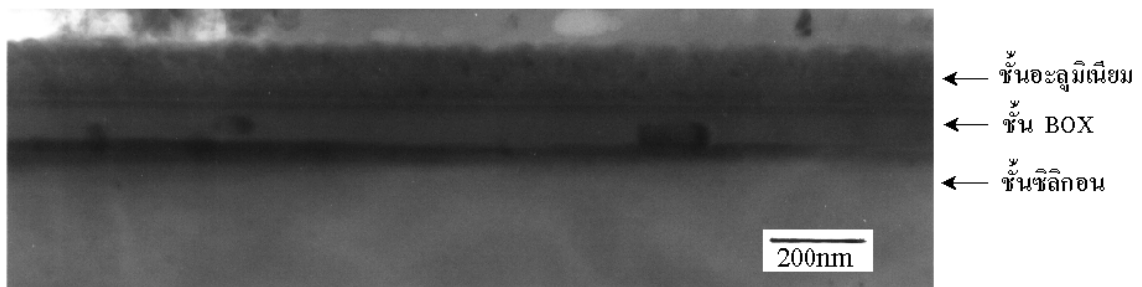
ภาพประกอบ 4.13 แสดงภาพถ่ายไมโครกราฟตัวอย่างไซม็อกซ์ ที่สร้างเป็นตัวเก็บประจุมอส ของตัวอย่างที่ฝังปริมาณออกซิเจน 3 \times 10^{17} ไอออนต่อตารางเซนติเมตร ที่มีชั้นป้องกันผิว (กำลังขยาย 1.6 \times 10^5 เท่า)
