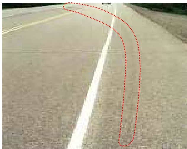
ภาพประกอบ 4.3 ลักษณะของรอยแฉลบ (Yaw Marks) (การขับรถซิดขวา)
