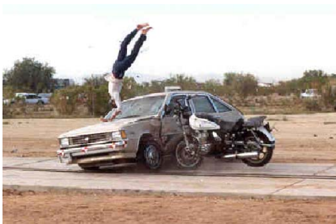
ภาพประกอบ 4.7 ภาพตัวอย่างการทดสอบการชนของรถจักรยานยนต์กับรถยนต์ที่ความเร็ว 40 ไมล์ต่อชั่วโมง (64 กม./ชม.) หลังจากชนแล้ว 0.33 วินาที ที่มา: Eubanks, 1999
