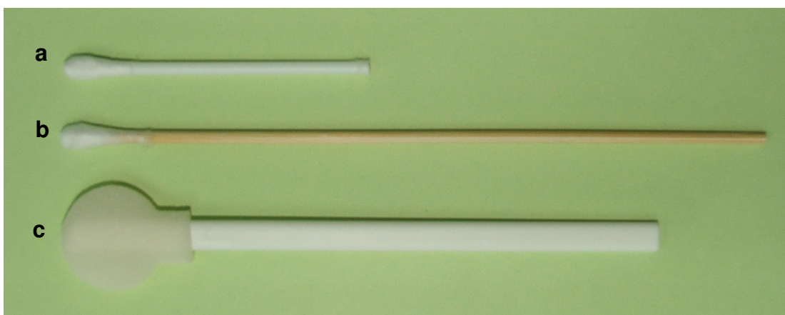
ภาพประกอบที่ 5 แสดงวัสดุที่ใช้ในการเก็บสะสมตัวอย่าง: a. Plastic shaft cotton buds, b. Wood shaft cotton buds และ c. Sterile foam - tipped applicator
