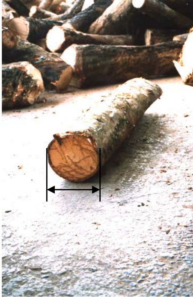
ภาพประกอบที่ 6 ตัวอย่างการแสดงเส้นผ่านศูนย์กลางหน้าไม้ยางพาราท่อน
