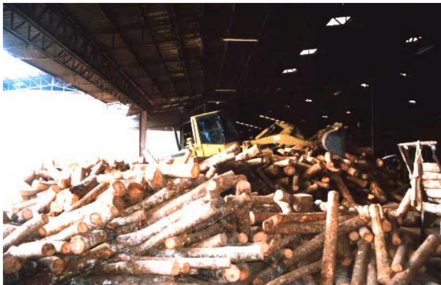
ภาพประกอบที่ 11 แสดงลักษณะการดันไม้ยางพาราท่อนเข้าหาโต๊ะเลื่อย
