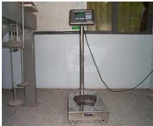
ภาพประกอบ 3.2 แสดงเครื่องชั่งน้ำหนักแบบไฟฟ้าที่ใช้ในการทดลอง
