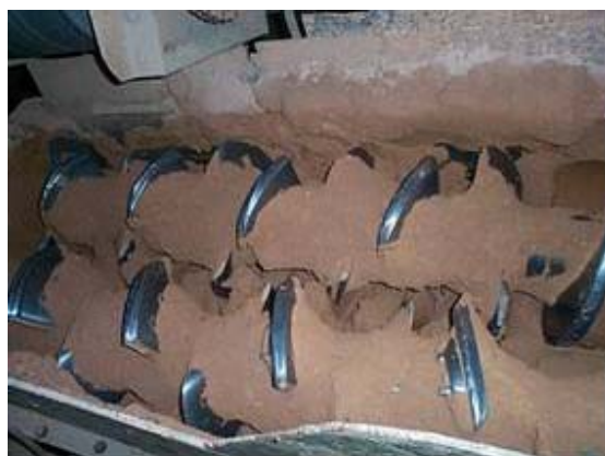
ภาพประกอบ 3.3 แสดงเครื่องผสมดินเหนียวที่ใช้ในการทดลอง
