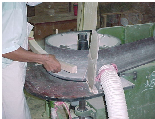
ภาพประกอบ 2-22 การขัดชิ้นงานด้วยเครื่องขัดสามเหลี่ยม
