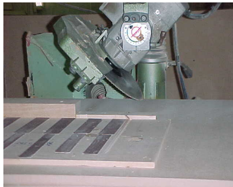
ภาพประกอบ 2-20 การตัดองศาด้วยการเอียงใบมีดเครื่องตัดละเอียด
