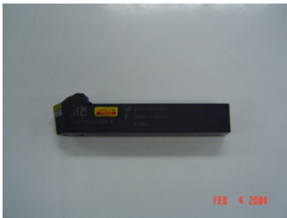
ภาพประกอบที่ 3.4 แสดงด้ามมีดที่ใช้ในการจับยึดใบมีด
