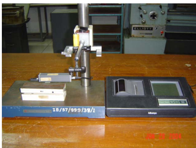
ภาพประกอบที่ 3.7 แสดงเครื่องวัดความขรุขระพื้นผิว ยี่ห้อ Mitutoyo รุ่น SJ – 301
