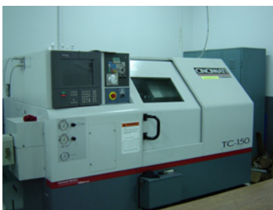
ภาพประกอบที่ 3.5 แสดงเครื่องกลึงอัตโนมัติ CNC ยี่ห้อ Cincinnati
