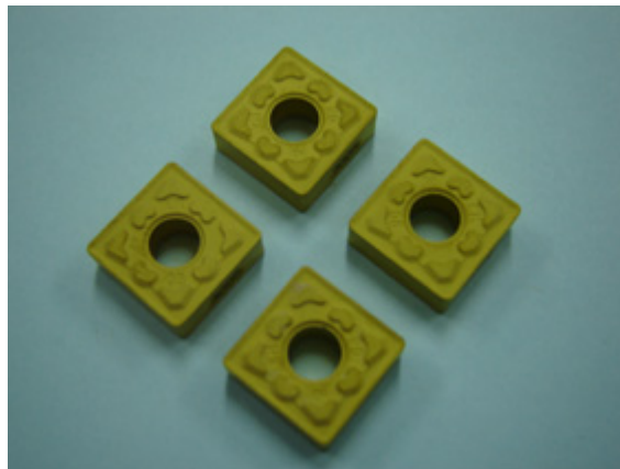
ภาพประกอบที่ 3.2 แสดงไบมีดคาร์ไบด์เคลือบผิว TiN-Al 2 O 3 -TiCN
