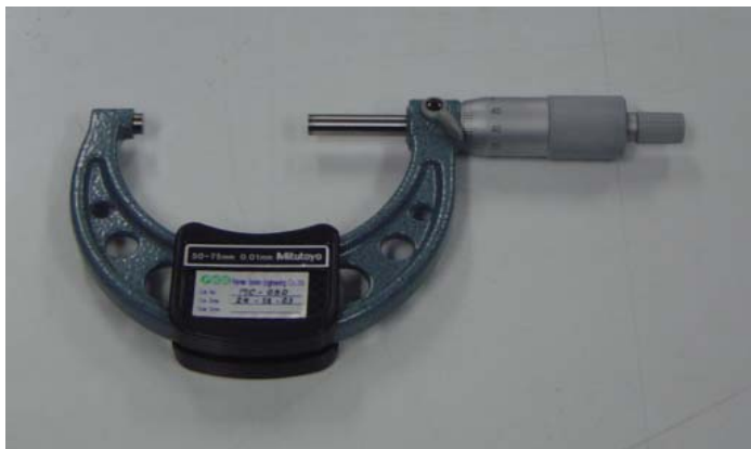
ภาพประกอบที่ 3.8 แสดงไมโครมิเตอร์ยี่ห้อ Mitutoyo
