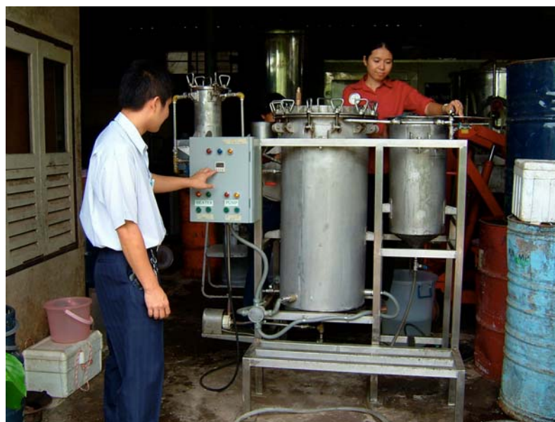
ภาพประกอบที่ 7 ชุดต้นแบบในการผลิตเมทิลเอสเทอร์แบบกะ
