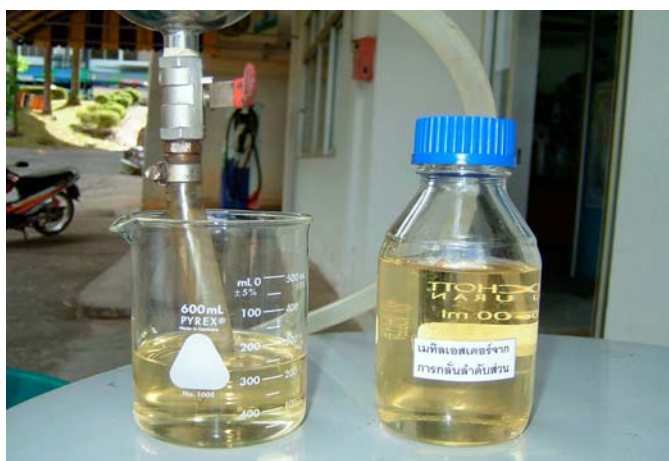
ภาพประกอบ 15 ลักษณะของเมทิลเอสเทอร์ที่ได้ทำปฏิกิริยาเอสเตอร์ฟิเคชันและการกลั่นใส
