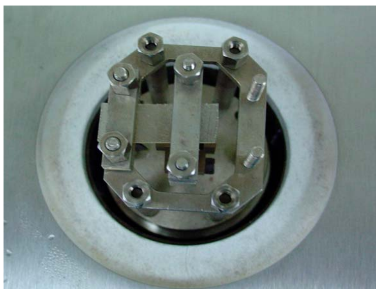
ภาพประกอบ 21 การวางชิ้นทดสอบในเครื่อง DMTA V 9002-50010
