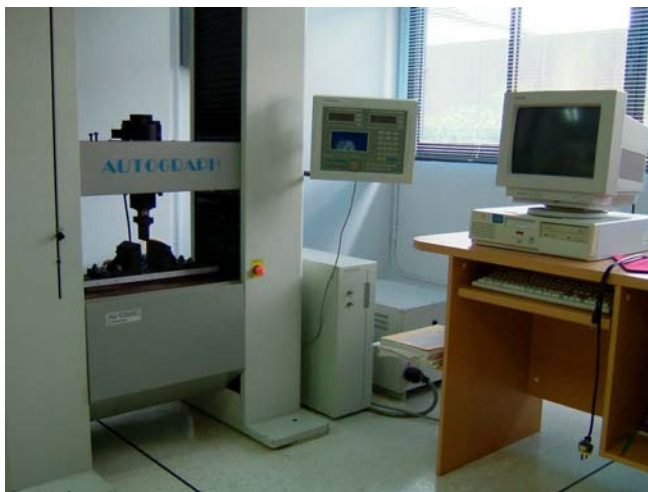
ภาพประกอบ 18 เครื่องทดสอบแรงดึงและแรงค้ำโค้ง, LLOYD®
