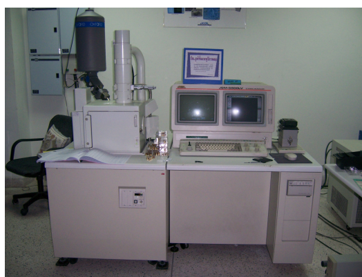
รูปที่ 2.14 Scanning Electro Microscope (SEM) ยี่ห้อ JEOL รุ่น JSM-5800LV
