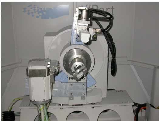
รูปที่ 2.12 X-ray Diffractometer (XRD) ยี่ห้อ PHILIPS รุ่น X'Pert MP
