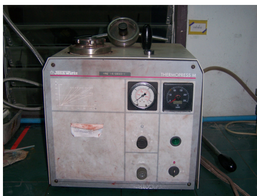
รูปที่ 2.9 เครื่องอัดสาร Thermo press ยี่ห้อ Jean Wirtz รุ่น Thermo press M
