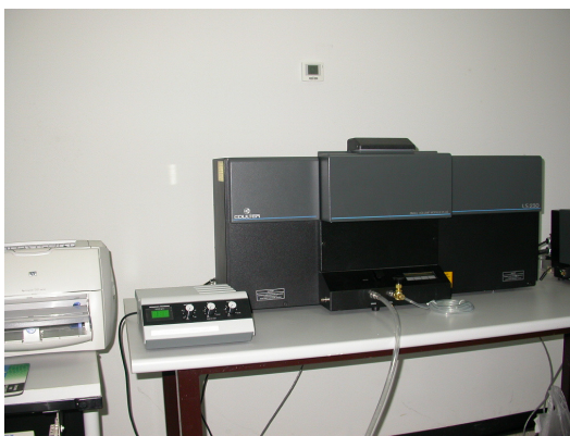
รูปที่ 2.13 Laser Particle Size Analyzer (LPSA) ยี่ห้อ COULTER รุ่น LS 230
