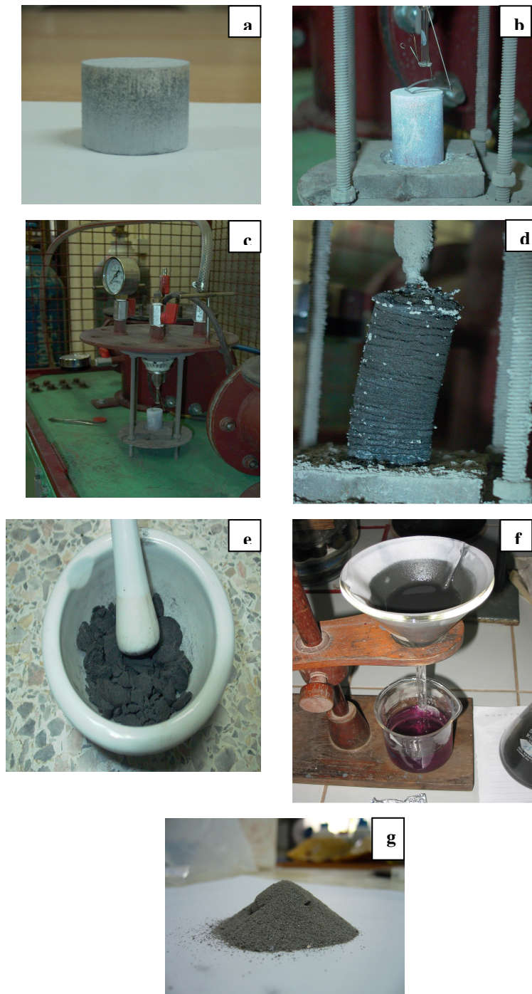
รูปที่ 2.17 แสดงภาพถ่ายขั้นตอนในการสังเคราะห์ผง TiB_2 (a) ชิ้นงานก่อนการสังเคราะห์ (b) การวางขวดหลอดทั้งสแตน (c) การวางชิ้นงานในเครื่องปฏิกรณ์ SHS (d) ชิ้นงานหลังการสังเคราะห์ (e) การบดชิ้นงานหลังการสังเคราะห์ (f) การชะละลาย (g) ผงผลิตภัณฑ์ TiB_2
