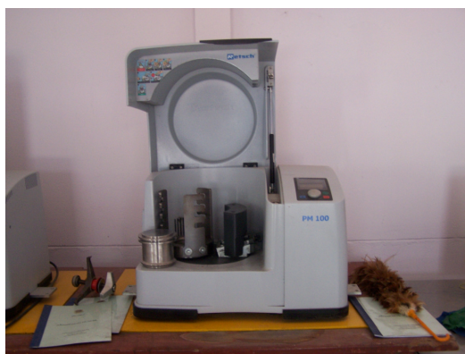
รูปที่ 2.8 เครื่องบด Planetary ball mill ยี่ห้อ Retsch รุ่น PM 100/200
