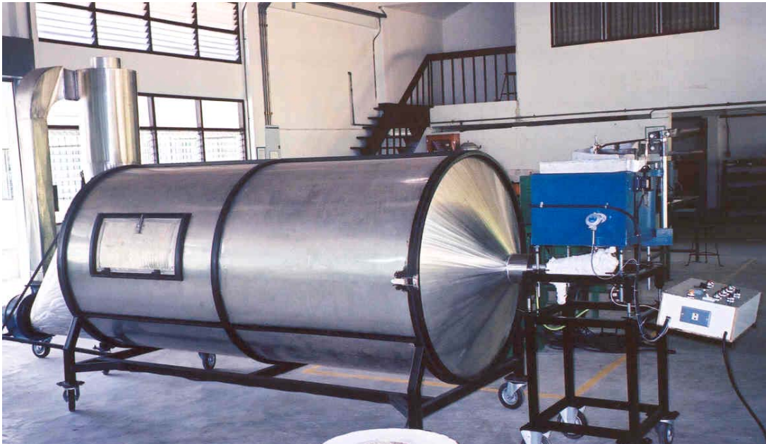
รูปที่ 3.17 ห้องพ่นโลหะเหลวที่สร้างเสร็จแล้ว
