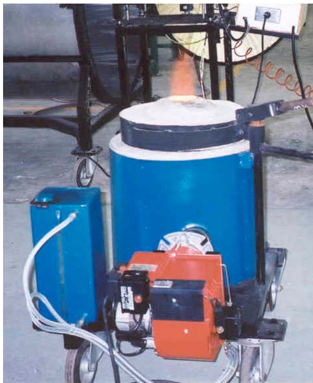
รูปที่ 3.21 เตาหลอมโลหะที่ดำเนินการสร้างตามแบบ
